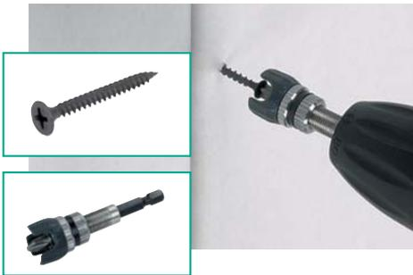
Die Befestigung der Gipskartonplatten auf der Unterkonstruktion (Beplanken) aus Holzleisten, Kanthölzern oder einem Metallständerwerk erfolgt mit speziellen Schnellbauschrauben. Diese stehen mit feinem Gewinde für Rahmen- und Ständerprofile und mit grobem Gewinde und unterschiedlichen Gewindelängen je nach Plattenstärke für Holzleisten oder Kanthölzer zur Verfügung. Als ideales Werkzeug zur Verarbeitung dient ein Akku-Schrauber mit elektronischer Drehzahlregelung.
